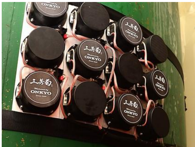
ホーロータンクに取り付けた加振設備
