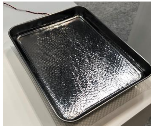
トレイの底面に付けた加振器の効果を波紋で表現
